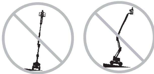
No confíe en la alarma de inclinación como indicador de nivelación. La alarma de inclinación sólo suena cuando la máquina se encuentra en una pendiente muy pronunciada.
