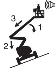
Cuando suene la alarma de inclinación con la plataforma descendente:
