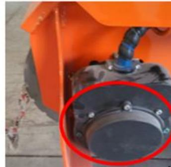
②Atornille el perno M6\*25 en los orificios roscados del disco de freno, véase la Figura2 ;
