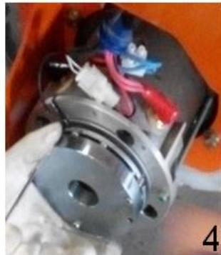
⑤ Repita el procedimiento anterior en el motor de accionamiento opuesto. Una vez liberados los frenos de ambos motores de accionamiento, la máquina se puede mover manualmente.
