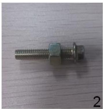
③ Atornille el perno M6\*25 en los orificios del disco de freno (vea la figura 3).
