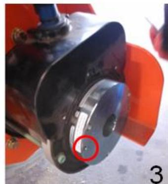
④ Gire la tuerca en sentido antihorario con una llave. Cuando la separación del freno es superior a 0,08 mm, el freno queda liberado.
